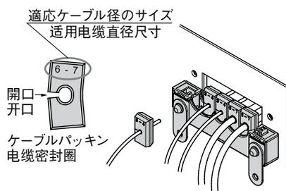
・適応ケーブルのサイズは丸形のみです。(異形、キズ、変形のケーブルは適応外です。)
