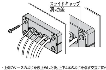
・上側のケースのねじを仮止めた後、上下4本のねじを必ず交互に締付けてください。
