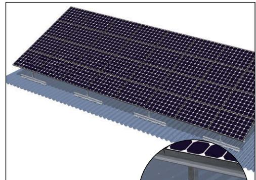
ルーフボルトにC-486-Mを固定し、太陽光架台を固定します。在屋顶螺栓上固定C-486-M，然后固定太阳能支座。
