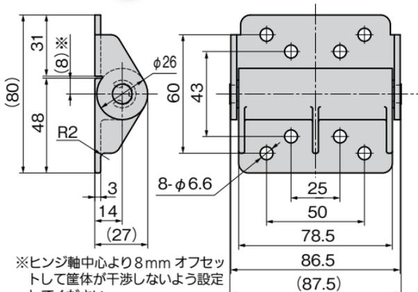
※ヒンジ軸中心より8mm オフセットして筐体が干渉しないよう設定してください。
