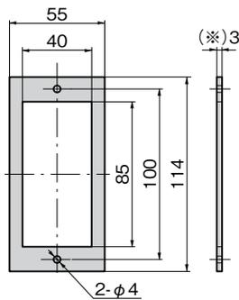
※A-1153-Pを取付けても、圧縮された状態で取手の内側に納まるためA-1153の突起高さ寸法(2)は変わりません。
