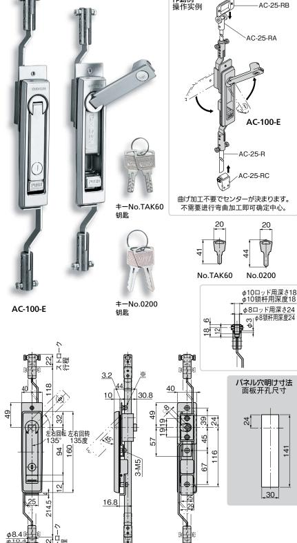
※本ねじはハンドルと筐体間にすき間が生じた時の調整ねじです。 ※当手柄与箱体之间产生间隙时,使用本调整螺丝进行调节。
